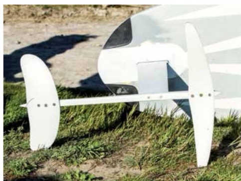
❷ Côté face, boîtier avancé et renforcé.
