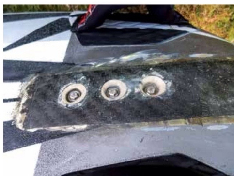
❶ Côté pile, renfort sur le pont de la planche.
